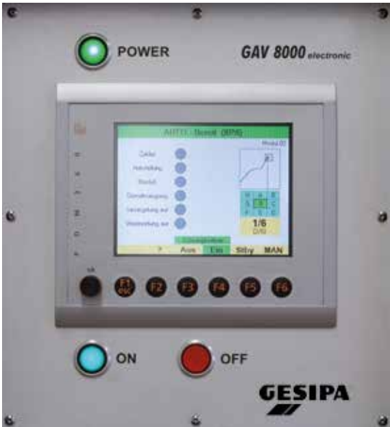
Display einer GAV 8000 electronic mit angezeigter Setzkurve als Teil der Setzprozessüberwachung
