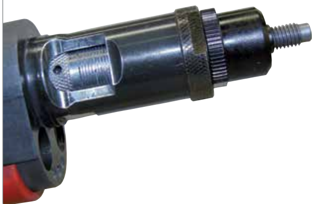
Смонтированный комплект оснастки
